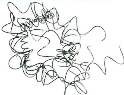
Längsdrehen ohne Spanformer (42CrMoS4+QT) / boring without chipformer (42CrMoS4+QT)
