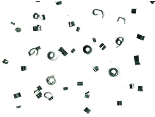
Einstechen mit Spanformer Typ D (42CrMoS4+QT) / grooving with chipformer Type D (42CrMoS4+QT)
